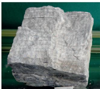
Figura 5. Muestra de cineritas volcánicas del techo de la capa 3ª en la mina Emma. Colección de ENCASUR, que se encuentra en la Escuela de Ingeniería Minera e Industrial de Almadén
