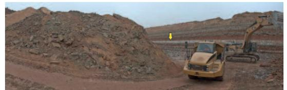
Figura 3. Frente de cantera aprovechando la ladera de un cerro. Mediante la flecha amarilla destacamos el nivel explotable de alabastro
