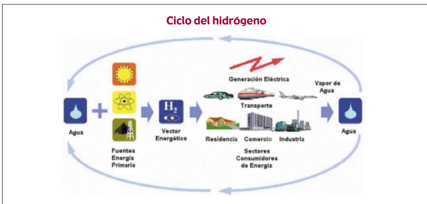
Actualmente, un porcentaje importante de la producción mundial de hidrógeno se consigue a partir del gas natural mediante un proceso conocido como “reformado con vapor de agua”. No obstante, el hidrógeno puede producirse a partir de una gran variedad de fuentes de energía primarias.
