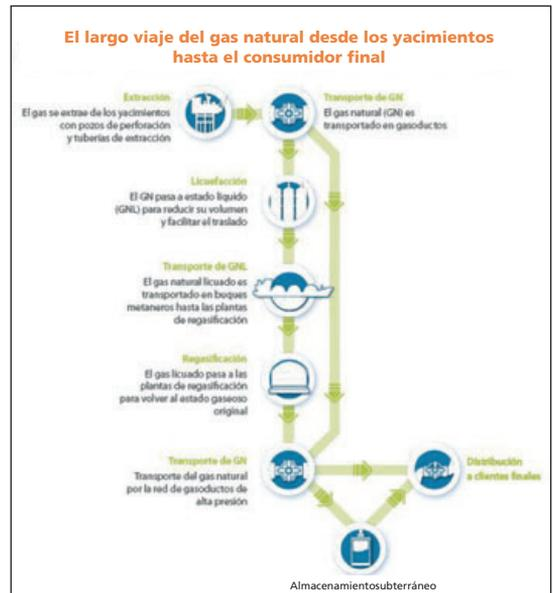
Algunos de los gases que forman parte del GN extraído se separan de la mezcla porque no tienen capacidades energéticas (N y  $\text{CO}_2$ ) o porque se pueden depositar en las tuberías usadas para su distribución, debido a su alto punto de ebullición. Sus emisiones de  $\text{CO}_2$  son un 40-50% menor que las del carbón y un 20-30% menor que las del fuel-oil, lo que reduce el impacto sobre el efecto invernadero y menor emisión de óxidos de N y de S. (Gráfico n.º 1)
