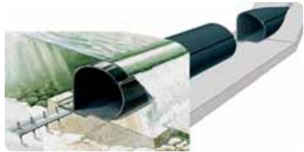
bloquea el paso del agua, cuando se desinfla, permanece extendida y plana sobre su fundación, permitiendo el libre flujo del agua, cumpliendo de esta manera la función de compuerta.
