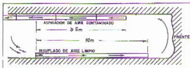
Fig. 16: Sistema de ventilación mixto en galerías subterráneas
