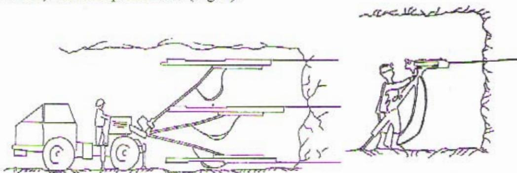
Fig. 2: Carro de perforación con sistema de inyección de agua
